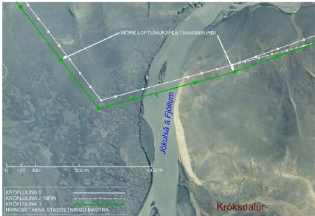
Mynd 4.7. Þverun Jökulsár með loftlínu, útfærsla e.
