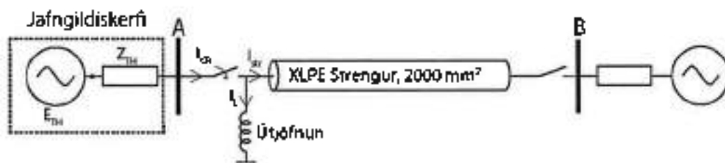
Mynd 9: Fjöfnun mynd af kerfi með streng, útjöfnun og rofbúnaði sem komst er við til útskýringar á „zero-missing“ fyrirbærinu.
